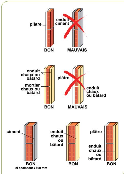
\* Les cloisons de doublage peuvent être enduites au plâtre THD ou à l'enduit de chaux ou bâtard moyennant la mise en œuvre d'attache (se référer au paragraphe sur les cloisons de doublage).
