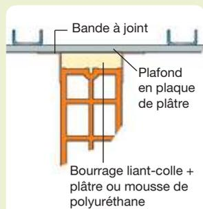
On peut utiliser de la mousse de polyuréthane expansée in situ comme préconisé ci-dessus.
