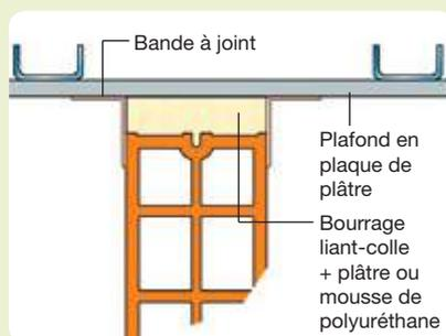
La jonction cloison / plafond s'effectue avec une bande à joints utilisée pour le traitement des joints du plafond.
