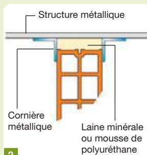
**Ces dispositions 1 et 2 sont particulièrement adaptées en zone sismique pour éviter le basculement en tête de cloison.**
