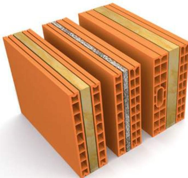
Les doubles cloisons sèches séparatives à haute performance acoustique **carrobric** sont constituées d'une cloison **carrobric**, d'un Panneau Acoustique Roulé en laine de verre et d'une seconde cloison **carrobric**. Celles-ci permettent d'atteindre des performances acoustiques élevées (de 52 à 65 dB) tout en garantissant, si les cloisons sont montées au liant-colle maçonnerie **carrobric**, un degré coupe-feu de 1 h 30 sans enduit.
