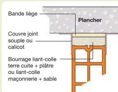
La jonction cloison/plafond est masquée par l'application d'un couvre-joint souple ou d'un calicot.
