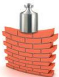
Les cloisons en briques supportent des efforts d'arrachement (efforts horizontaux perpendiculaires à la cloison) de 25 daN, soit environ 25 kg et des charges suspendues (charges verticales) de 50 daN, soit environ 50 kg.
