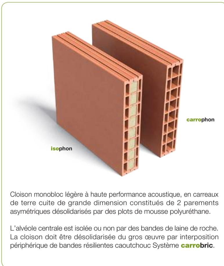
Cloison monobloc légère à haute performance acoustique, en carreaux de terre cuite de grande dimension constitués de 2 parements asymétriques désolidarisés par des plots de mousse polyuréthane.
