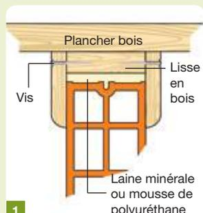
On peut également fixer, en sous face de la structure, un ensemble permettant l'emboîtement de la cloison (cornières métalliques, lisse en bois à laquelle sont vissés deux tasseaux...) et garnir le vide intérieur de laine minérale ou de mousse de polyuréthane.
