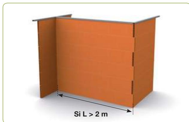
Les cloisons non tenues en tête, doivent dans certains cas, être pourvues de raidisseurs horizontaux constitués d'une coiffe de maintien qui sera positionnée en haut de la cloison.
