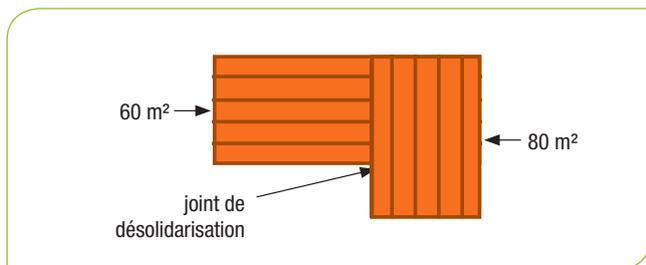
Dans ce cas, une partie du plafond est supérieure à 110 m<sup>2</sup>, ce n'est pas conforme à l'avis technique.
