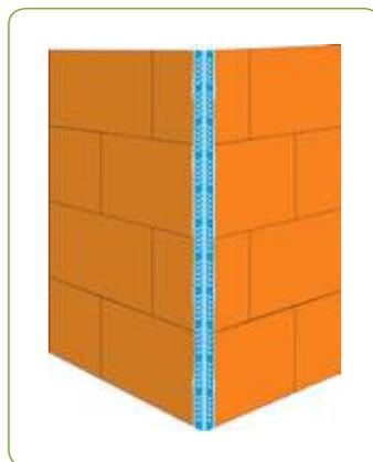
Harper 1 rang sur 2 les **carrobriac** et coller en angle une arête finie en métal pour cloison sèche.
