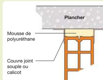
Il est également possible d'utiliser de la mousse de polyuréthane expansée in situ. Dans ce cas, la bande résiliente en liège n'est pas nécessaire.
