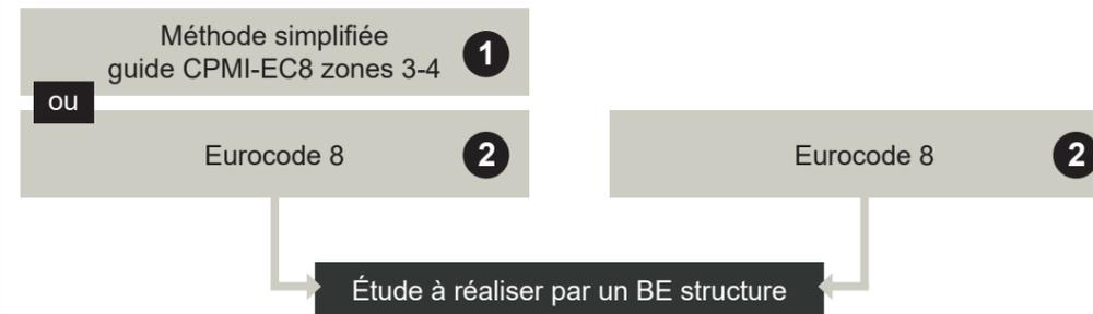
L'étude du projet réalisé par le BE structure consiste à déterminer les longueurs de mur de contreventement minimales, leurs positionnements, ainsi que les positionnements des chaînages et leurs sections de ferrailage.
