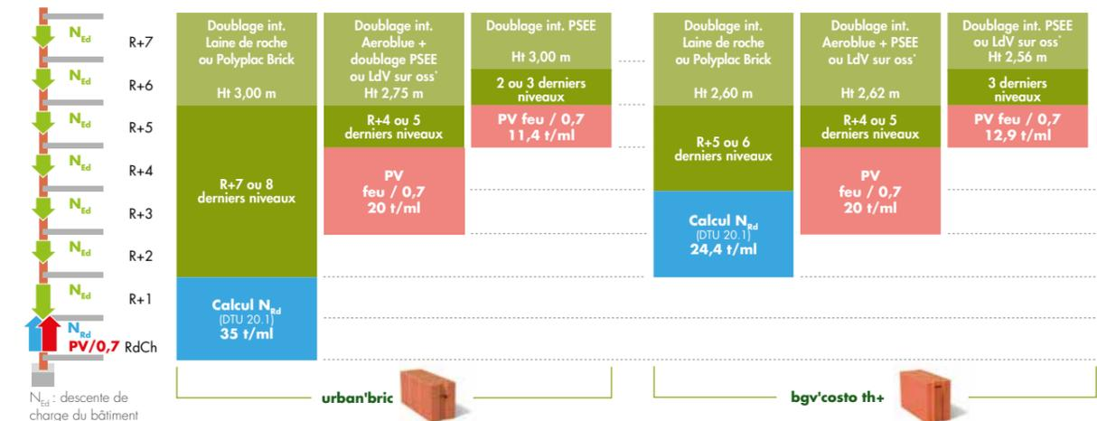
Les calculs de  $N_{Ed}$  et  $N_{Rd}$  ont été effectués avec les hypothèses suivantes : Ht de mur 2,50 m – Portée des planchers 6,00 m – Plancher béton Ep 20 cm – Toiture lourde + acrotère Haut – Niveau de contrôle IL1
